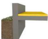
**Ajout d'une isolation sur le plancher bas : 120 mm de polystyrène expansé (PSE) + chape - R = 3.0 m<sup>2</sup>.K/W - Surface isolée = 34 m<sup>2</sup>**
