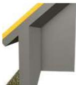
**Ajout d'une isolation de la toiture par l'extérieur : 140 mm de panneaux sandwich + couverture - R = 6.3 m<sup>2</sup>.K/W - Surface isolée = 52 m<sup>2</sup>**
