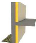
**Remplacement de l'isolation des murs extérieurs par : 140 mm de laine de bois en panneaux + doublage intérieur - R = 3.8 m<sup>2</sup>.K/W - Surface isolée = 112 m<sup>2</sup>**
